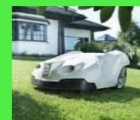
Robot tondeuse : capteurs qui identifient les limites du terrain, la hauteur de l'herbe, ordinateur qui transmet les informations aux actionneurs (roues et lame)
